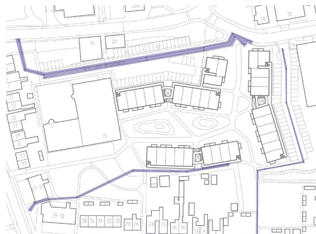
ligging riool, aansluiting op bestaande rioolsysteem
