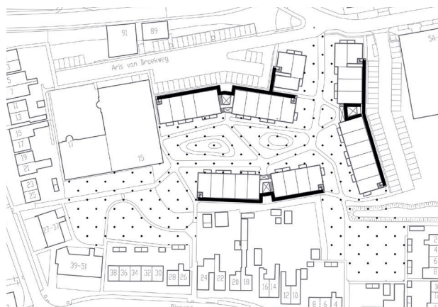
ontsluiting appartementen via galerijen en centrale entreehallen
